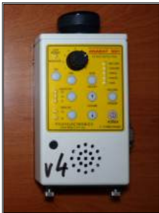
Détecteur à ultrasons modèle ANABAT
