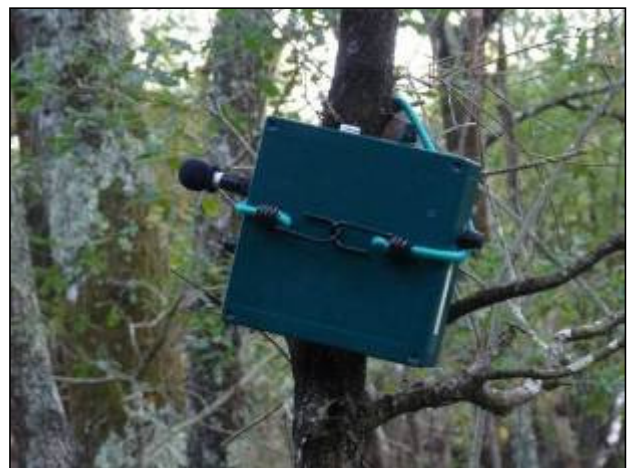
Station fixe d'enregistrement automatique des signaux de chiroptères avec système SM2BAT. Le dispositif est fixé sur un arbre.
